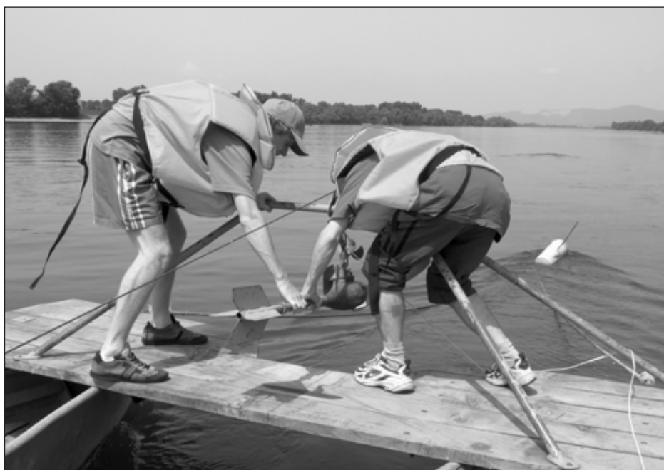
13. ábra. Vízsebességmérés mérőtutajról a Műegyetem alsógödi mérőtelepén (2007)
