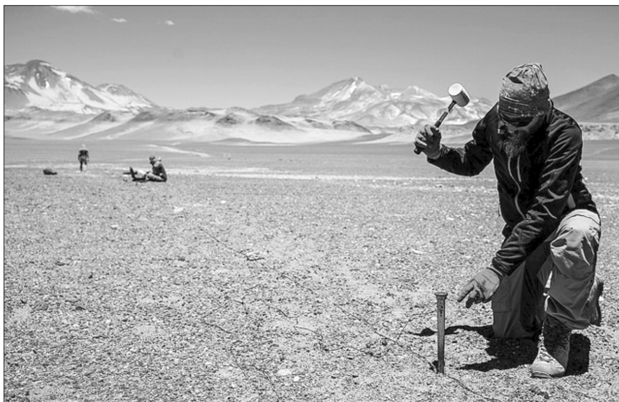
A chilei Puna de Atacama fennsíkon Nagy Balázs a magyar kutatóprogram keretében geoelektromos szondával a Föld legmagasabban működő örökfagy-mérőrendszerét építi (2016)
